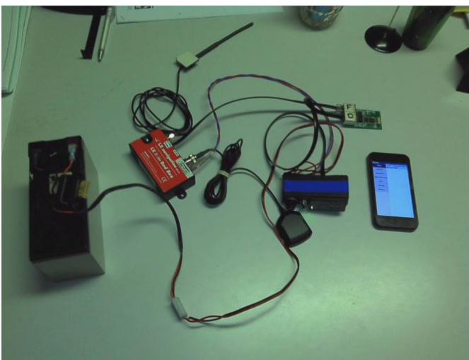
Image 4. Alimentation 12V fournie au FLARM RedBox. Le FLARM fourni 3,3V au BT1 et à l'afficheur externe LX. Le BT1 est connecté entre le LX RedBox et l'afficheur externe. Désolé pour le fouillis sur la photo.
