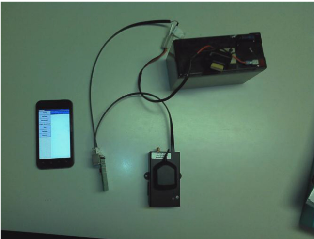
Image 3. Alimentation 12V fournie par le connecteur RJ45/RJ12 intégré au module BT1. Le module BT1 est alimenté par l'alimentation 3,3V fournie par le FLARM.
